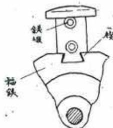
第 15.9 図 薄鉄板磁極の取付
