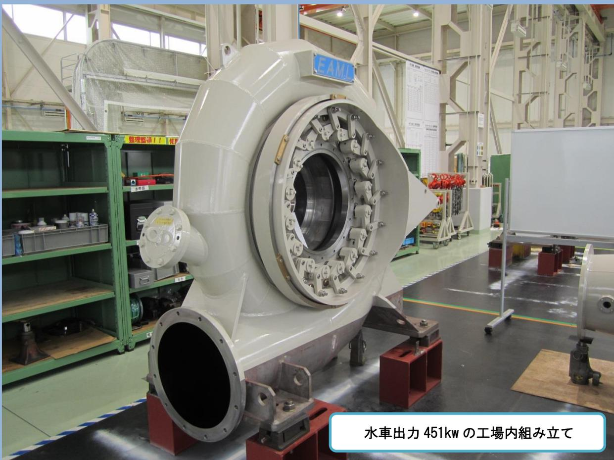
水車出力 451kw の工場内組み立て
